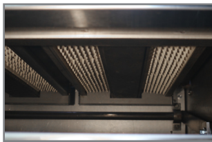
Radiant Burners -Gas- Max Temp: 1000°F
