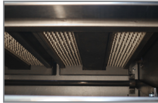
Radiant Burners -Gas- Max Temp: 1000°F
