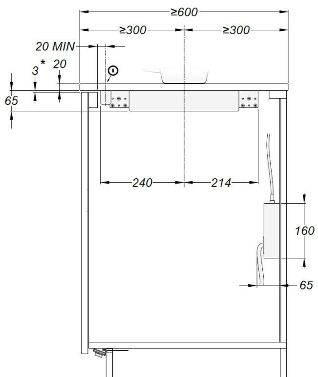
\* Ventilation: Pour un refroidissement suffisant, prévoyez une ouverture d'aération d'au moins 3mm juste sous le plan de travail sur toute la largeur de la plaque de cuisson.
